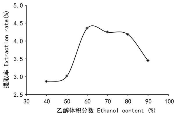
图2 乙醇体积分数对金缕半枫荷总多酚提取率的影响
