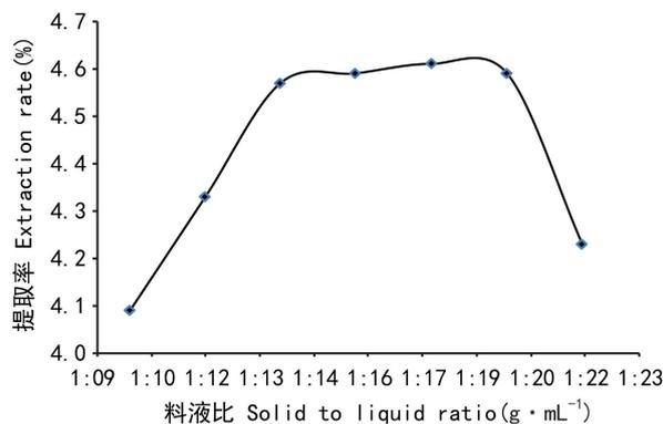
图3 料液比对金缕半枫荷总多酚提取率的影响
