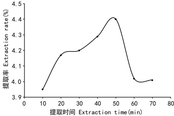
图 4 提取时间对金缕半枫荷总多酚提取率的影响
