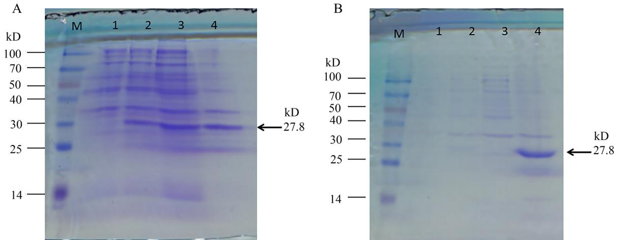
**A.** 16 °C, 100 r · min<sup>-1</sup>, 0.5 mol · L<sup>-1</sup> IPTG 诱导下的 PtCHI; **B.** 30 °C, 100 r · min<sup>-1</sup>, 0.5 mol · L<sup>-1</sup> IPTG 诱导下的 PtCHI; **M.** Protein marker; **1.** 未诱导的总蛋白; **2.** IPTG 诱导的总蛋白; **3.** IPTG 诱导的上清液; **4.** IPTG 诱导的沉淀。
