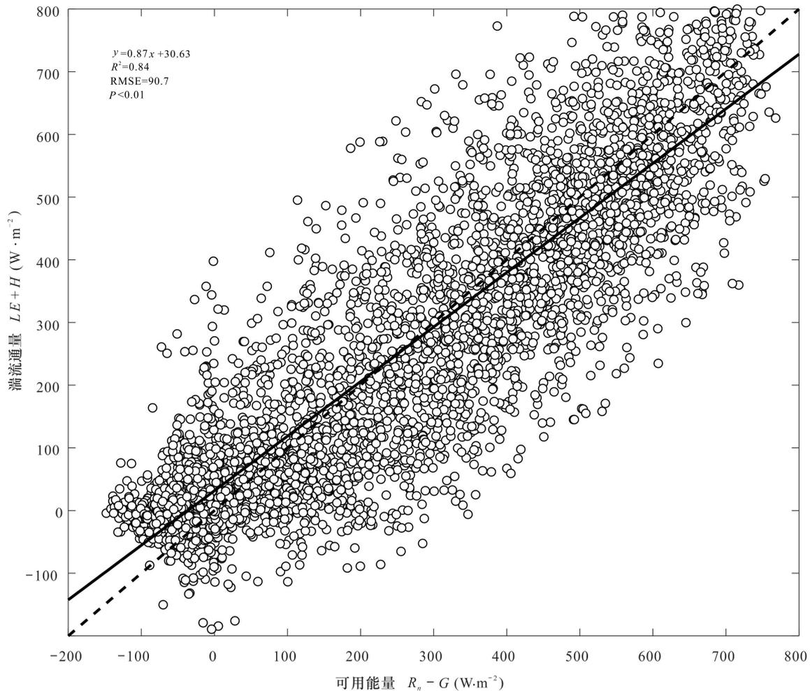
图 1 全生长季半小时能量平衡闭合分析
